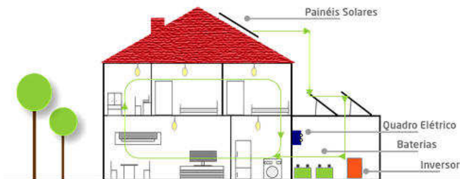
Figura 2.15 - Exemplo de sistema fotovoltaico isolado. Fonte: d-solarsystems.com.
